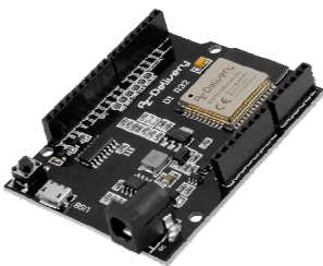
Carte à base de microcontrôleur ESP
