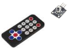
Télécommande + récepteur IR
